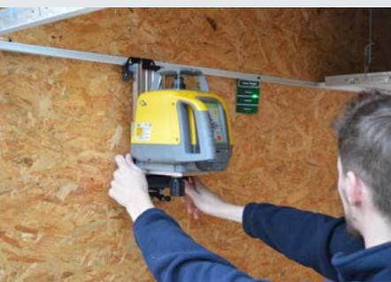
Il laser autolivellante a fascio rosso Spectra Precision® HV1305C e quello a fascio verde HV1305GC sono i laser più robusti ed economici in grado di fornire la funzione di allineamento sia orizzontale che verticale. Anche in condizioni di lavoro sfavorevoli, i laser offrono prestazioni sempre affidabili e accurate, per un lavoro più rapido e intuitivo.
