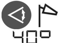
Un appui sur la touche Scan permet d'accéder au mode Scan au réglage le plus petit de 10°. Des appuis supplémentaires sur la touche permettent de générer 5 dimensions différentes de ligne laser (10°, 20°, 40°, 60°, 80°) ; elles sont affichées à l'écran.
