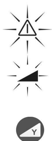
Falls sich das Gerät durch äußere Einwirkungen wie Erschütterungen oder starke Temperaturunterschiede in seiner Lage verändert, wird der Rotationsbetrieb automatisch unterbrochen. Dadurch werden Fehlmessungen vermieden. Der Laserstrahl, das Neigungssymbol und die Warnanzeige im Display blinken schnell.
