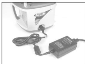
**Nota:** a seconda della batteria e di quanto è scarica, è necessario attendere 6-10 ore per una carica completa usando il carica-batterie intelligente.
