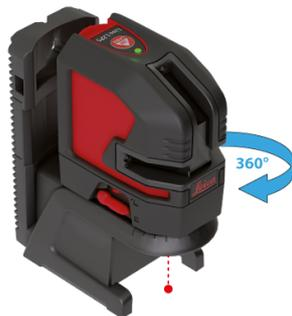
Ruotare lo strumento di 360° attorno al punto di messa a piombo per regolare la linea verticale.
