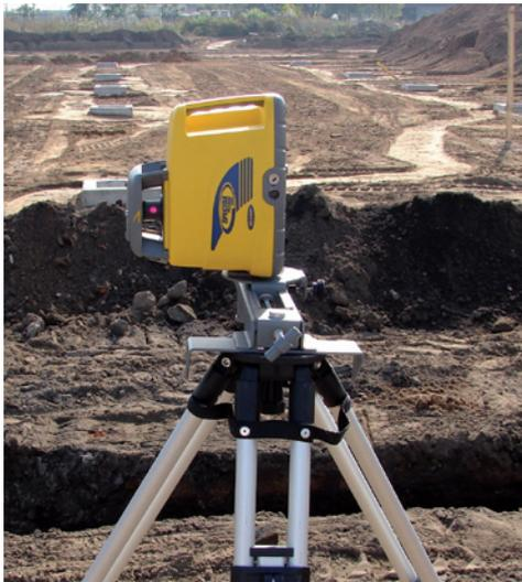
Le lavorazioni all'interno del cantiere richiedono spesso la realizzazione di allineamenti tra due o più punti conosciuti. GL412 e GL422 sono in grado di creare un perfetto piano verticale che consente, utilizzando il ricevitore in posizione orizzontale, di unire più punti muovendo l'asse di riferimento tramite il radiocomando.
