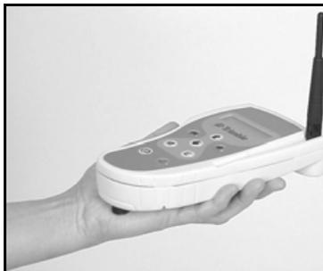
Se si connette il radio telecomando ad un'asta di livello e lo si orienta verticalmente, l'antenna deve indicare verso l'alto dalla parte superiore del radio telecomando.
