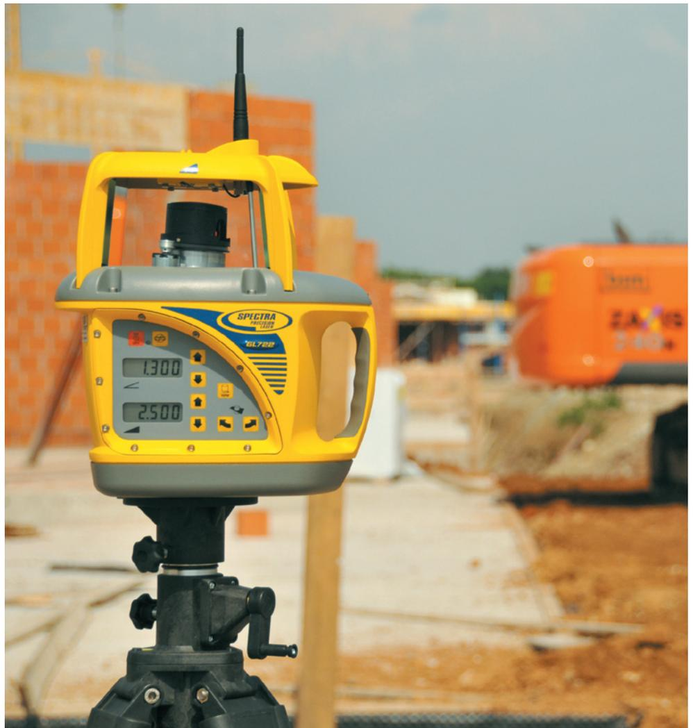
la serie di livelli laser autolivellanti GL700 si compone di strumenti in grado di eseguire piani in singola ed in doppia pendenza a inserimento digitale. i modelli della gamma GL700 sono uguali fra loro per prestazioni ma differenti nelle funzionalità.
