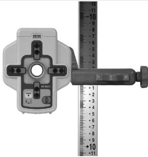
L'SF601 montato su una stadia con la clip del ricevitore standard
