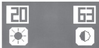
3. Per modificare il contrasto del display LCD, ruotare l'interruttore multifunzione destro. I cambiamenti sono nell'ordine di 1 unità. L'intervallo è compreso tra 45 e 100.
