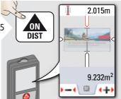
Selezionare le frecce con i tasti cursore o toccando il display e regolare con i softkey. Viene calcolata l'area.
