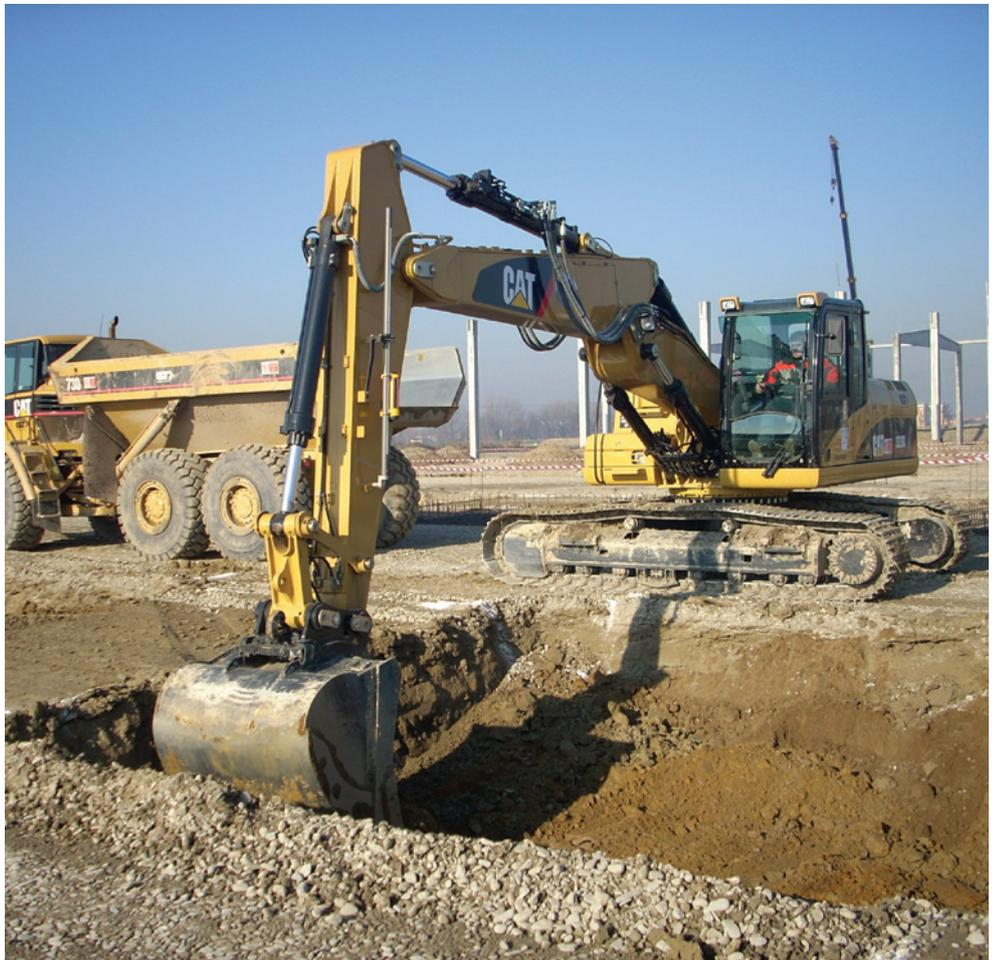
i ricevitori laser LR possono essere utilizzati sia su di un escavatore per il controllo della profondità di scavo che su macchine da livellamento per il controllo, in manuale o automatico, dei movimenti della lama.
